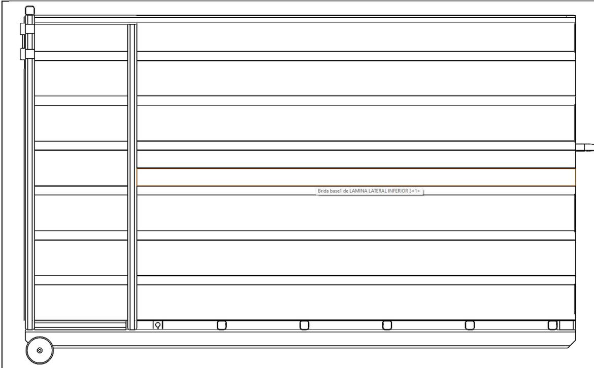
CARACTERÍSTICAS: DISEÑO ERGONÓMICO EN ACERO ASTM A-36 Y PERFILES ESTRUCTURALES A500, PAREDES LATERALES Y FRONTALES CON LAMINA TROQUELADA QUE AUMENTA LA RESISTENCIA AL IMPACTO, SOLDADURA MIG, PINTURA A DOS MANOS DE PRIMARIO ANTICORROSIVO Y DOS MANOS DE ESMALTE ALQUIDALICO COLOR A ELECCIÓN DEL CLIENTE, RODILLOS, BISAGRAS Y JALÓN EN ACERO 1045.
